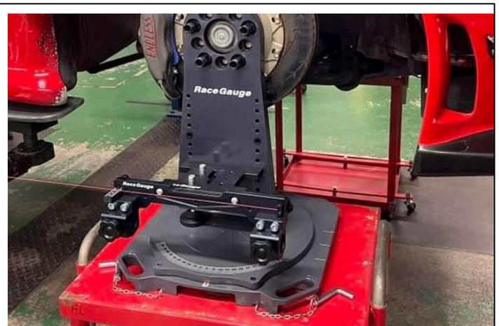
ターニングラジアスゲージによって安定した再現性を実現
